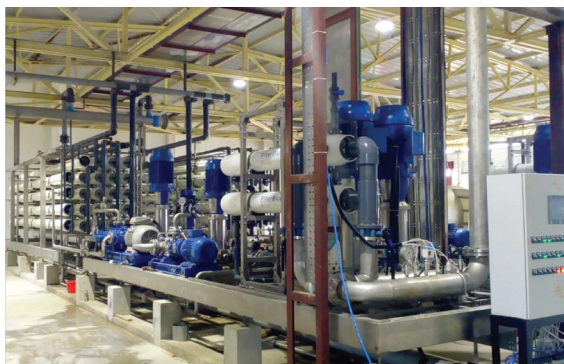
Impianto RO, recupero fino a 96% di permeato
